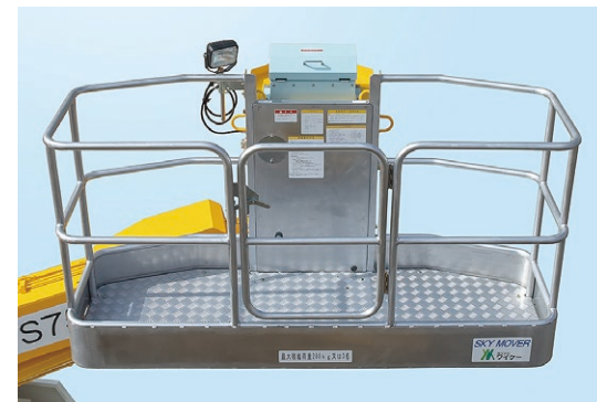
大型バスケットの採用で作業効率が大幅アップ 積載荷重280kg (または3名)
