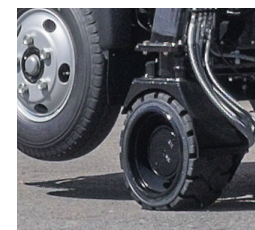
逸走の心配がない油圧メカブレーキを採用
