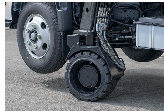
油圧メカブレーキを採用したジャッキ兼用の移動タイヤ (前進・後進、左右20度ステアリング可能)
