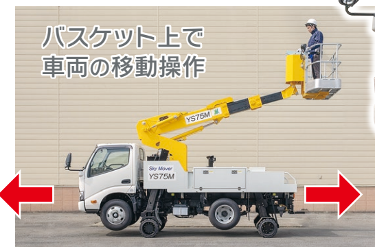
大型バスケットの採用で作業効率が大幅アップ 積載荷重280kg (または3名)
